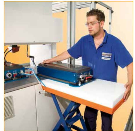
Abb.: Austausch der "Vario Unit" an Maschinenrückseite mit Hilfe der "Service Unit" (Lieferumfang)
