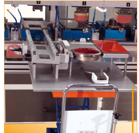
Abb.: "Cliché Unit 210" (Option) - Montagehilfe für Austausch Klischee/Farbe
