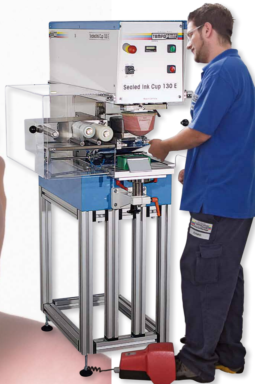
"Sealed Ink Cup 130 E", ausgestattet mit einer Restfarbenabholung, Alu-Profil-Ständer und x/y Kreuztisch, ist ein ergonomischer Stand-alone Arbeitsplatz.
