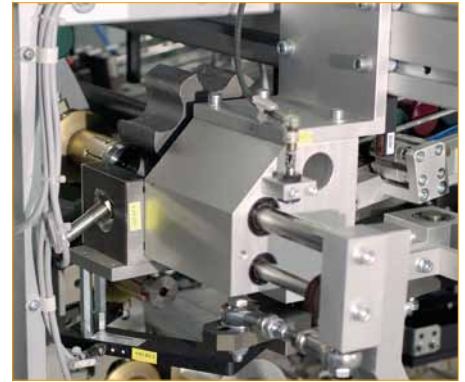
Img.: Estación de avance así como sistema especial de útil de fijación para la pieza con mecanismo de sujeción.
