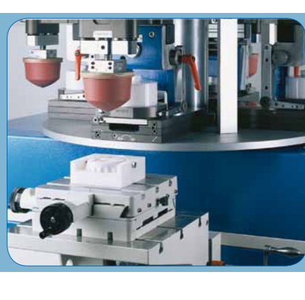
"Concentra" con un util (mesa en cruz x/y de AL.)
