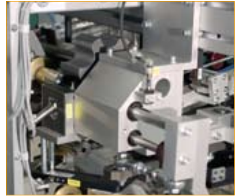
Illustration : station d'introduction avec système de chariot porte-pièce et mécanisme de tension
