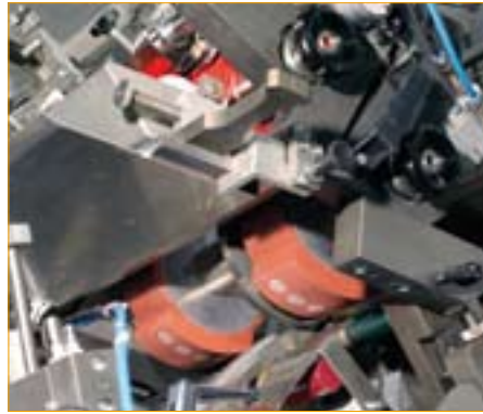
Illustration : gros plan d'un cylindre tampon lors du processus de transfert
