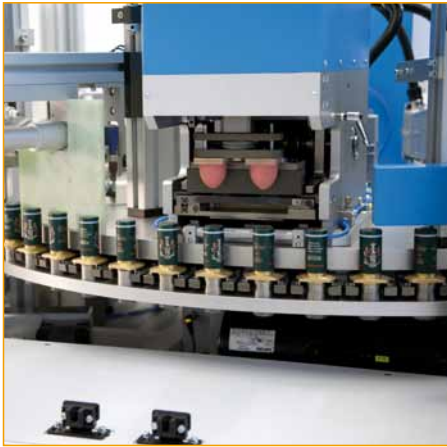
Exemple de combinaison "Top Spin LC" (Impression circulaire) + "Speed Modul" (Impression en face) Impression de LongCaps (bouchons).
