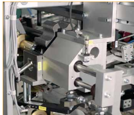
Illustration : station d'introduction avec système de chariot porte-pièce et mécanisme de tension
