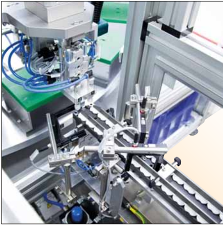
Alimentation à manipulation d'entrée pneumatique double (aspirateur sous vide)
