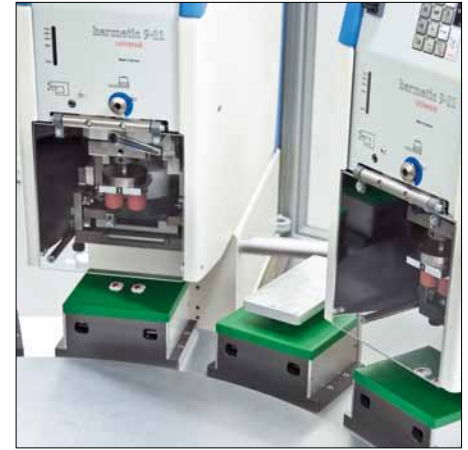
Station de séchage intermédiaire pour impression "humide sur humide"
