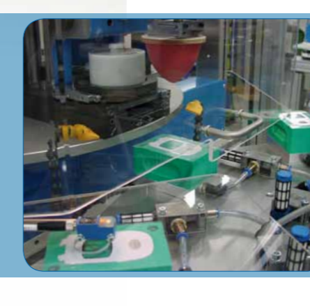
"Concentra 90-4" avec plateau tournant, porte-pièce avec support vacuum
