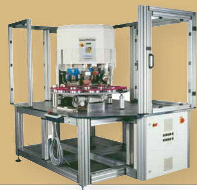
Augmentation du rendement de la "V-130 DUO" par montage d'un "Modul 2000"
