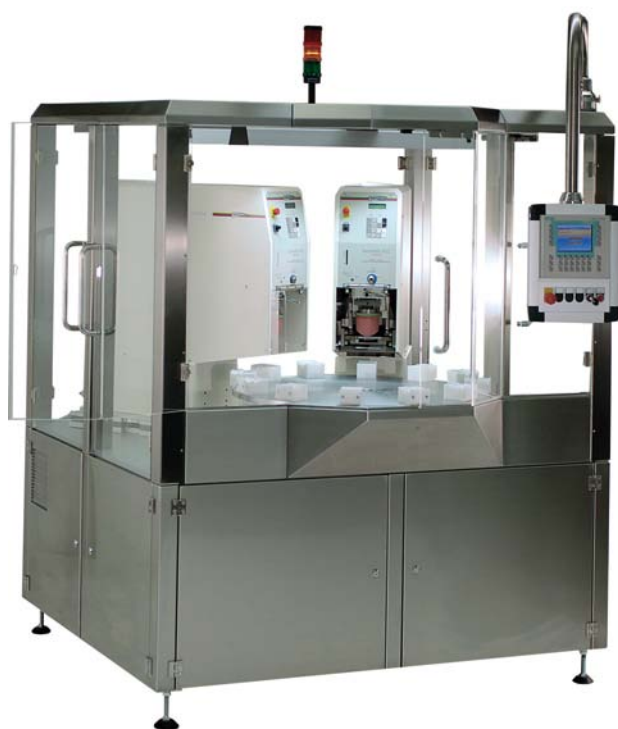
MODUL 2010 avec 2 machines de tampographie "Hermetic 9-11 Universal"
